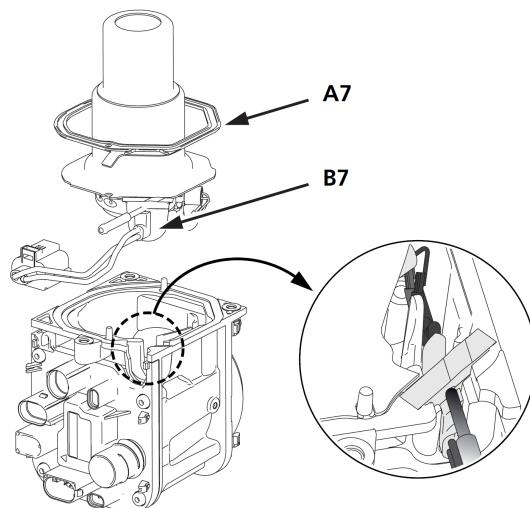
**Рис. 902 Горелка и нагнетатель воздуха для горения**
