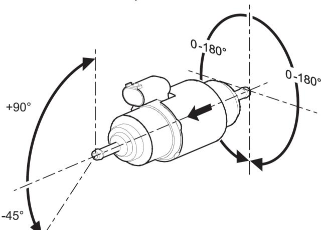
Рис. 804 Установочные положения насоса-дозатора DP42
