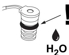
Рис. 918 Смачивание уплотнений
