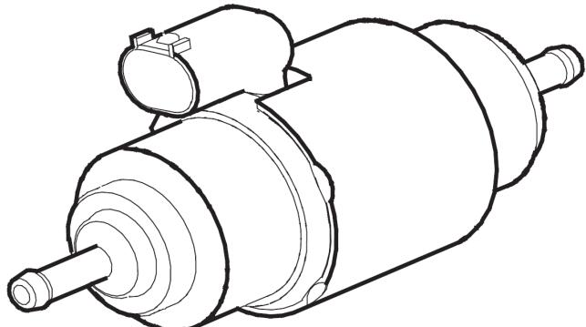
Рис. 206 Насос-дозатор DP42
