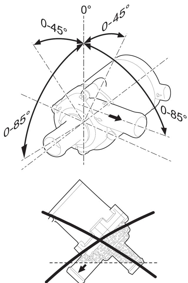
Рис. 802 Установочные положения циркуляционного насоса U4847 Econ
