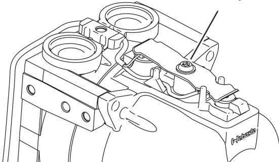
Рис. 921 Затяните винты
